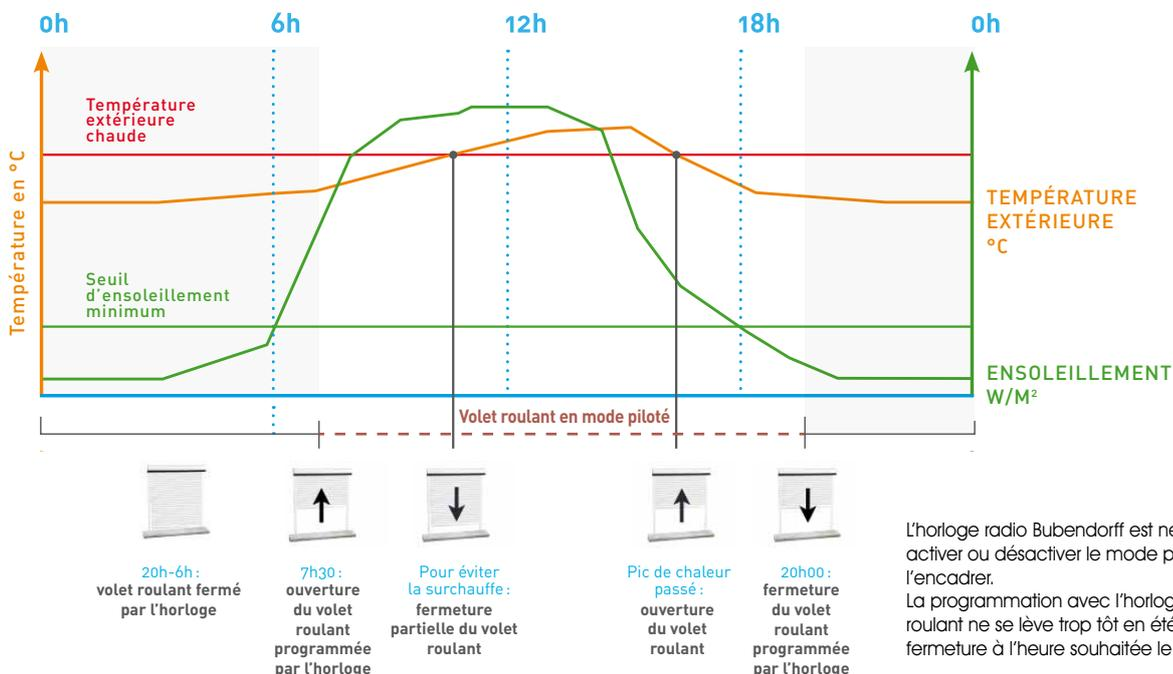
L'horloge radio Bubendorff est nécessaire pour activer ou désactiver le mode pilotage, et l'encadrer. La programmation avec l'horloge évite que le volet roulant ne se lève trop tôt en été, et elle force la fermeture à l'heure souhaitée le soir.
