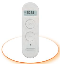
L'horloge 4 canaux permet de programmer l'ouverture et/ou la fermeture automatique des volets/iD-Zip, aux horaires désirés. Elle permet en outre de piloter manuellement jusqu'à 4 groupes de 30 volets/iD-Zip.
